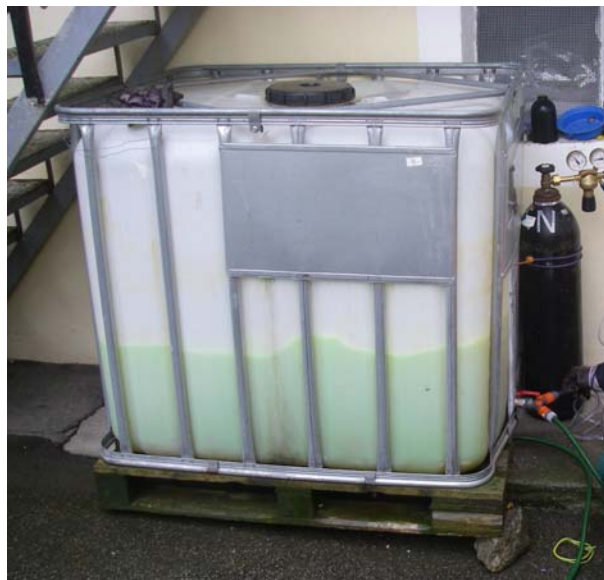
Abbildung 4: Mischung von Standortwasser mit Wirk- und Markierungsstoffen (Laktose, Uranin) vor der Reinfiltration unter Luftabschluss durch N 2 -Athmosphäre (Foto: Scherr, IFA-Tulln).
